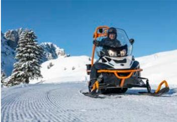
Zu den Schneeraupenfahrzeugen gehören Pistenfahrzeuge, Motorschlitten, Kleinmotorfahrzeuge oder Traktoren (Quads) mit Raupen. Während Pistenfahrzeuge hauptsächlich für die Präparation von Skipisten eingesetzt werden, dienen die übrigen Schneeraupenfahrzeuge dem Personen- und Sachentransport.
